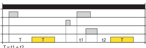
Nach Zufuhr der Versorgungsspannung wird das Relais geöffnet. Ist der Steuerkontakt START geschaltet, beginnt die Zeitverzögerung T. Nach Ablauf des Timings bzw. Countdowns öffnet das Relais und die Zeitverzögerung T läuft erneut. Nach Ablauf des Timings öffnet das Relais wieder und die Sequenz wird bis zum Trennen der Versorgungsspannung wiederholt.
